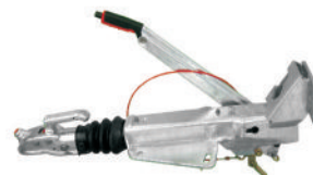
Auflaufeinrichtung 2512G / 1500-3000 kg mit Stützradkonsole
